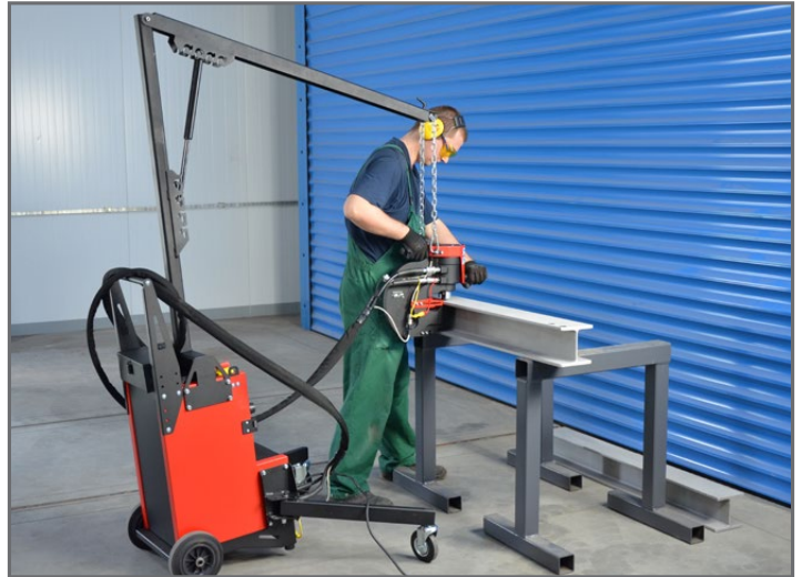
Schlaucharm und 2 Träger mit Rädern erlauben einen einfachen Einsatz von Stanzer und Hydraulikstation als eine Einheit.
