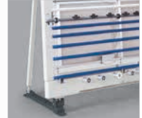
▶ Automatisch ausweichender Lattenrost, um zu verhindern, dass das Sägeblatt in eine Rückwandlatte hineinsägt
