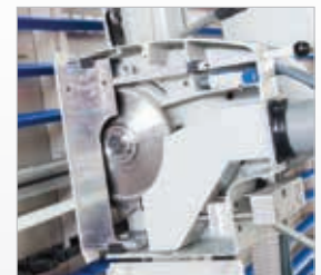
▶ Große Öffnung für Sägeblattwechsel
