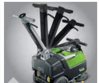
Neigungsverstellbare Lenkstange Lässt sich in Höhe und Neigung verstellen, um stets eine bequeme Bedienung zu gewährleisten. Nach dem Gebrauch lässt sie sich platzsparend komplett einklappen
