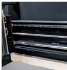
▶ Die über Kugelumlaufspindeln angetriebene X-Achse läuft auf doppelter Linearführung
