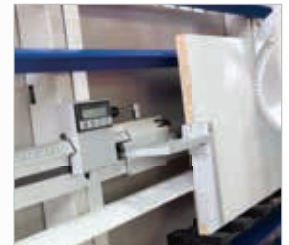
▶ Digitale Maßanzeige zur Längeneinstellung beim Vertikalschnitt
